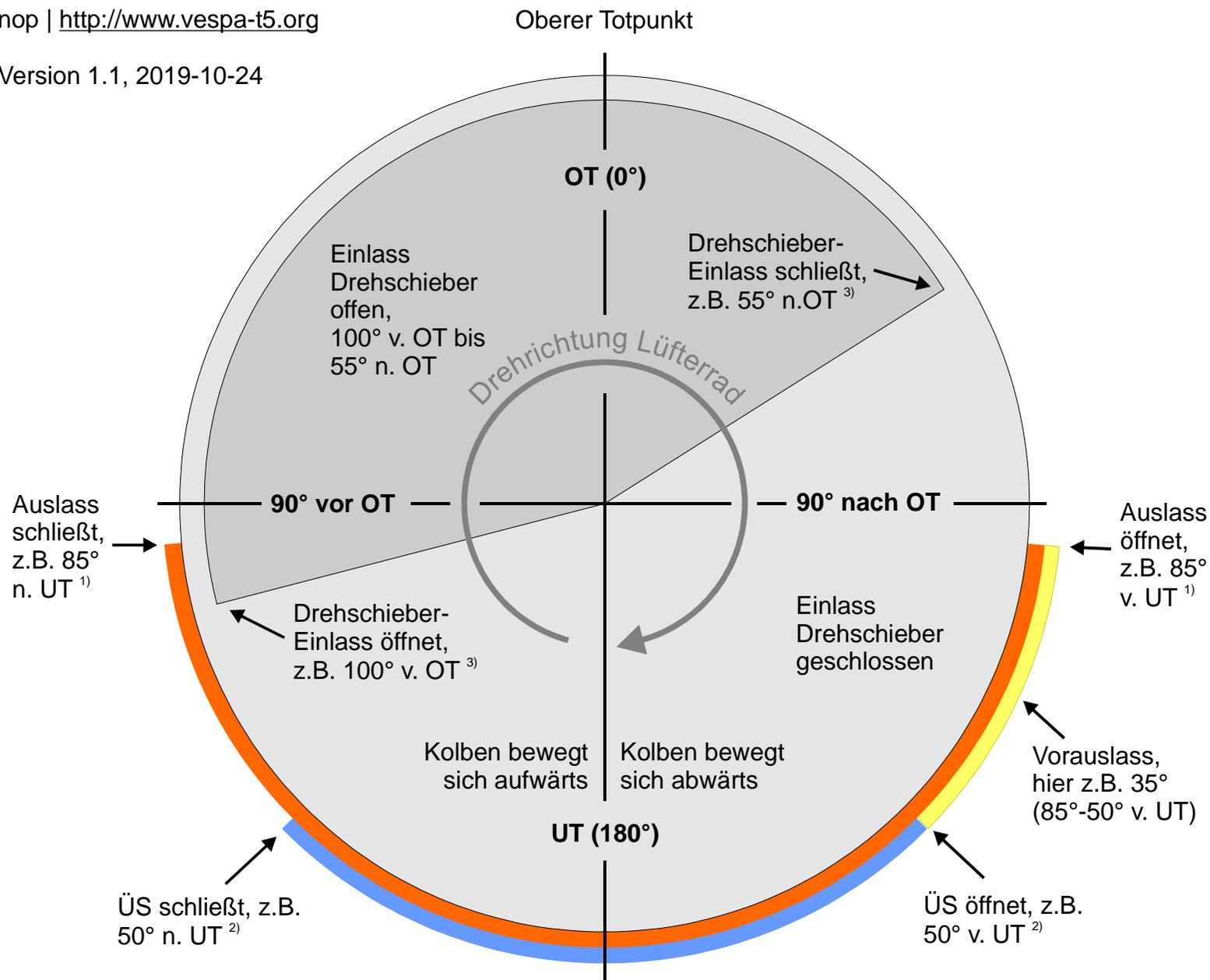
Alle kolbengesteuerten Zeiten (Auslass, Überströme) sind symmetrisch, da vom Kolben auf dem Weg nach oben und unten "an der selben Stelle" überlaufen.
